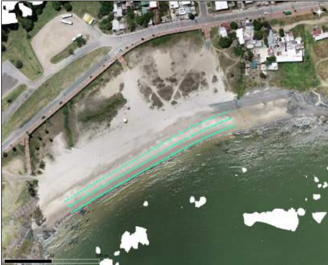
Figura 4-38 – Retroceso esperable de la línea de costa por efecto de un aumento del nivel medio del mar de 20 cm y 40 cm, calculado con el modelo ShoreTrans.
