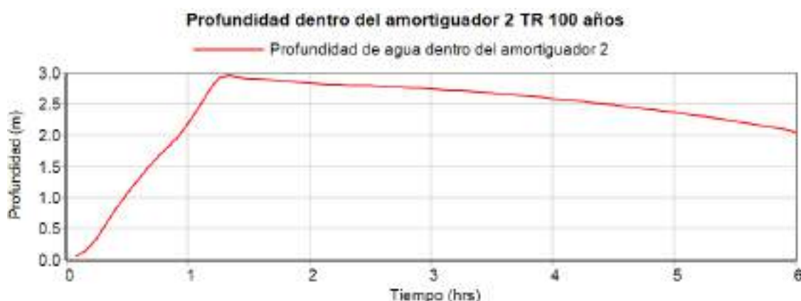
Figura 4-79: Profundidad del agua dentro del amortiguador 2 para TR 100 años.
