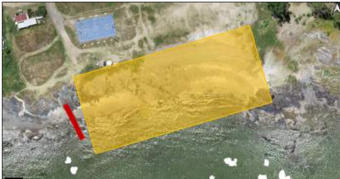
Figura 4-58 – Esquema de zona a rellenar (amarillo) y ubicación de espigón de contención para limitar pérdida de arena del tramo Este hacia el tramo Oeste.
