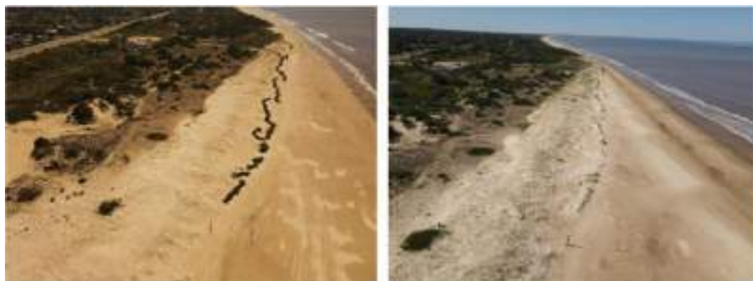
Figura 4-68: Resultados antes y después de colocación de cercas en Ciudad de la Costa (proyecto Municipio Ciudad de la Costa, Organización local Guardianes de la Costa)
