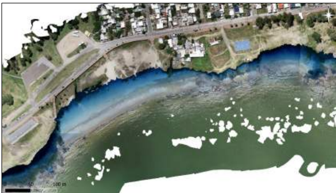
Figura 4-40: Ejemplo de las manchas de amenaza de inundación costera obtenidas con la metodología propuesta para Tr 100 con un aumento del nivel medio del mar de 40 cm.
