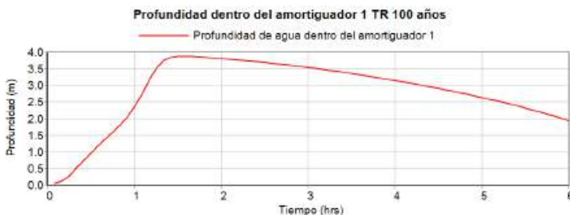
Figura 4-78: Profundidad del agua dentro del amortiguador 1 para TR 100 años.
